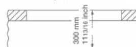
Ausschnittmaß Seitenansicht Cut-out dimension, side view Côte de coupe, vue de côté
